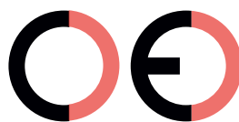
Faux marquage CE (trop éloigné)
